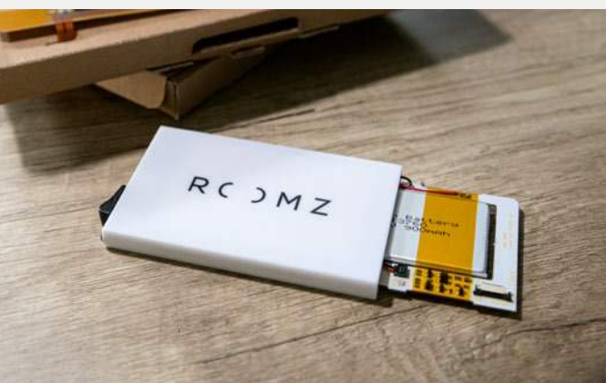
Ladeelektronik mit wiederaufladbarer LiPo-Akkuzelle
